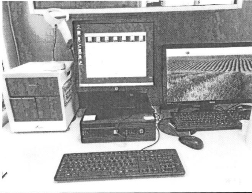
Fig. 4 Sistema modulare per diagnostica rapida in urgenza destinata a problem solving ginecologia, interventi chirurgici non programmati. turnaround-time analisi COVID 19 - 45 minuti
